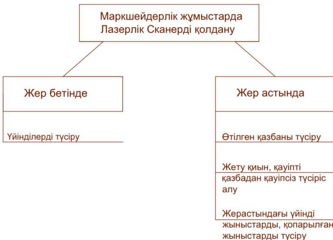
3.1-сурет – Кен орнындағы лазерлік сканерді қолдану түрлері
